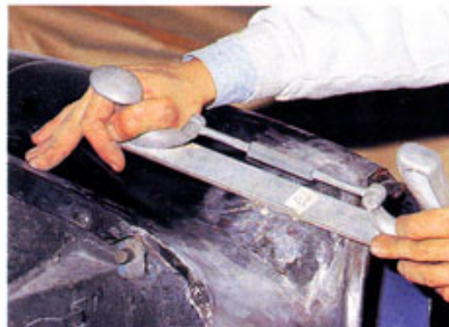
Die Karosseriefeile sorgt für glatte Übergänge zwischen Zinn und Blech
