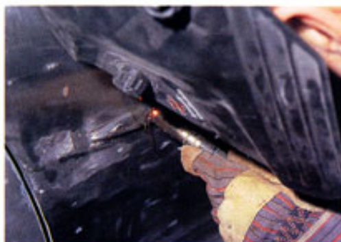
Die typischen „Radlauf-Augenbrauen“ waren nur noch in aufwendiger Handarbeit zu retten
