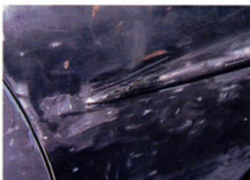
Bei einer Spachtel-Reparatur wäre diese Kante bald wieder zum Sorgenkind geworden
