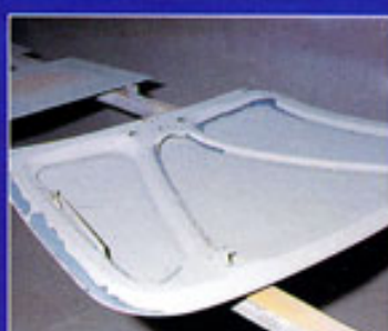
Ein Rest des alten Thermoplastlacks ließ die Grundierung abplatzen!
