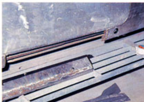
Keine Rettung für die maroden Schweller: Ein Neuteil war hier die beste und billigste Lösung
