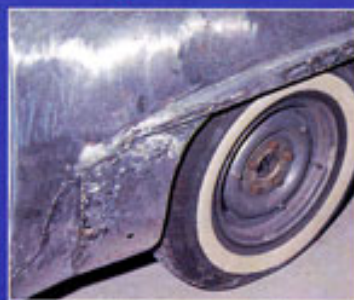
Nicht schön, aber selten: Radlauf mit angepapptem Reparaturblech
