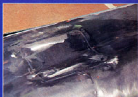
Nach dem Verschleifen der Nähte fällt der fachgerecht eingesetzte Flicker kaum noch auf
