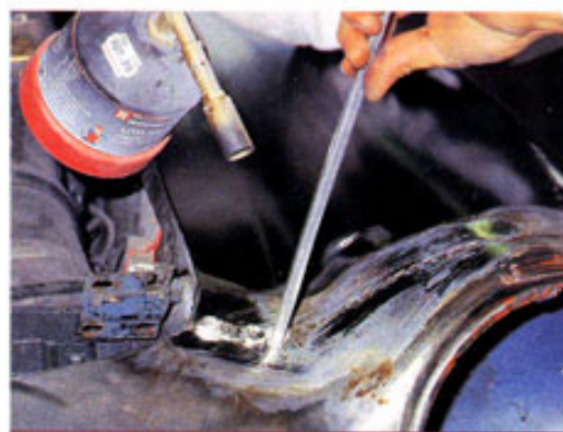
...altes Handwerk zum Tragen. Die Schweißnähte wurden sauber verschliffen und verzinkt
