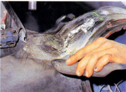
Mit dem Formholz bringt der Karosseriebauer das flüssige Metall grob in Form
