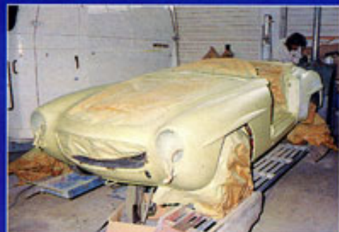
Nach allen Blecharbeiten folgt die grünliche Rostschutzgrundierung auf Epoxidbasis
