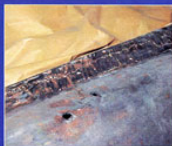
Eigentlich sollte nur das alte Loch für die Antenne zugeschweißt werden
