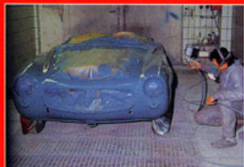
Jetzt kommt Farbe ins Spiel: Die eigentliche Lackierung dauert nur knapp drei Stunden
