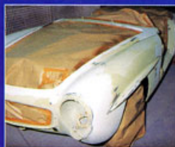
Fleckig: Durchschliffstellen in der Spachtelmasse sind unvermeidlich
