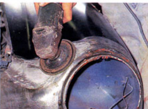
Feinarbeit mit Winkelschleifer und Sandpapier: Hier reicht später ein Hauch Spachtel
