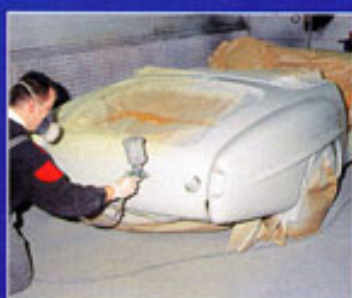
Erst dann folgt der Auftrag des grauen Spritzfüllers
