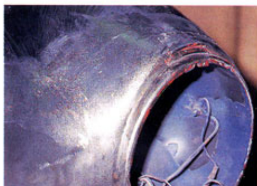
Das Zinn bildet eine glänzende Grundlage für den späteren Lackaufbau
