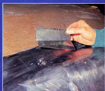
Die klassische Rost-Kur: Neues Blech zuschneiden und anpassen...
